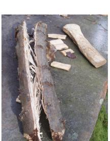
Figure 12a, 12b, 12c, 12d: Technique des coins en bois(buis): on enfonce un premier coin en extrémité puis un deuxième un peu plus bas tout en gardant le premier en écarteur et ainsi de suite jusqu'à séparation progressive des deux moitiés de la branche
