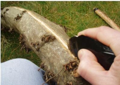
Figure 10: Mise en place d'une rainure guide par sciage sur le plan médian de la pièce
