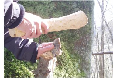
Figure 11: Essai de fendage avec éclat de silex en extrémité de la pièce de bois
