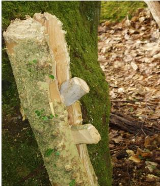
Figure 16: Insertion des coins suivant la même procédure. Les coins en buis et bois de cervidés ont entre 20 et 30 ° d'angle et 2,5 à 4 cm de largeur
