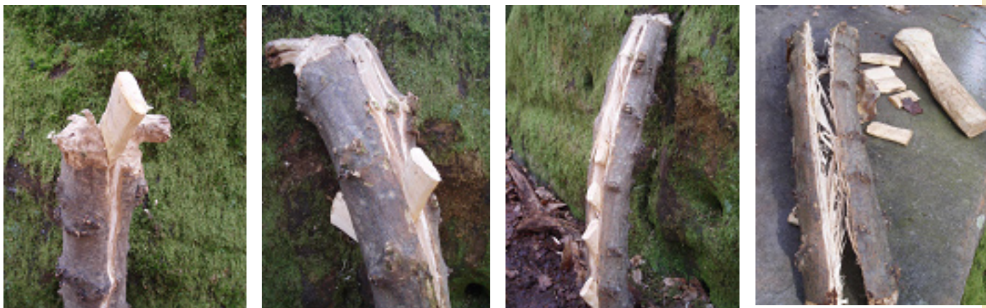
Insertion progressive des coins de buis dans la pièce de bois à l'aide d'un maillet
