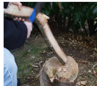
Fig 4: Dégrossissage à la machette en dégageant une surface plane sur une face de la pièce.
