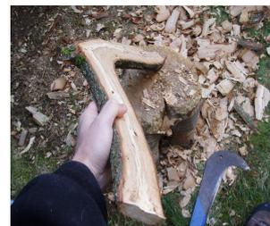
Fig 5 : Puis sur l'autre, de façon à créer une préforme, au deux faces parallèles, la plus plane possible.
