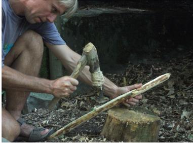
Fig 8: Dégrossissage à la petite herminette lame perpendiculaire à la surface inclinée sur un billot. Avec les grandes herminettes on travaille en général plutôt debout, objet à plat sur le sol avec pied dessus pour le coincer.
