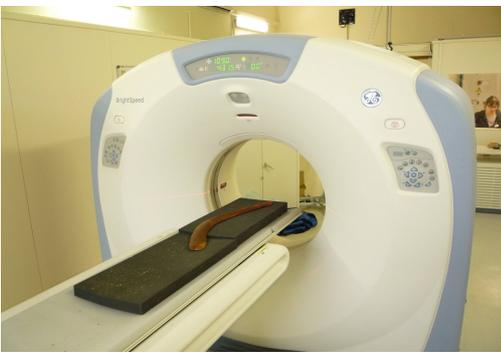
Fig 14 : Objet 1017 sur le plateau de l'appareil de tomographie avant le lancement du scan.
